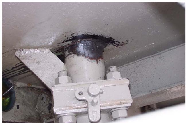
Öl trat aus mikrofeinen Rissen an durch Vibration beschädigten Schweißnähten aus. Der Ausfluss an Öl vergrößerte sich durch einen erfolglosen Versuch die Instandsetzung durch herkömmliches Schweißen vorzunehmen. Dann wurde entschieden, die Reparatur gemäß der Technologie des "direct-MM-bonding" durch Gebrauch von MM-metall oL-StahlKeramik mit Härter rot durch eine anschließende Beschichtung von MM-metall oL-StahlKeramik mit Härter gelb durchzuführen.
