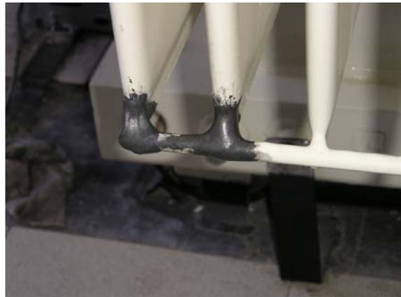
Die Verschweißungen an 19 Stellen wiesen mikrokleine Risse und Gaseinschlüsse auf, aus denen Öl austrat. Zunächst wurde der Anstrich an den beschädigten Stellen mit einem Elektrobohrer samt Schleifaufsatz entfernt und das Metall gesäubert. Danach wurde MM-metall oL-StahlKeramik mit Härter rot, anschließend MM-metall oL-StahlKeramik mit Härter gelb aufgetragen. Nach Überprüfung der Dichtigkeit der instand gesetzten Stellen wurden die entsprechenden Bereiche abschließend neu lackiert.
