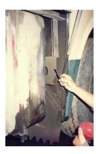
Abdichtung einer Leckage eines Kraftstoffbehälters mit MM-metall oL-StahlKeramik und Härter rot nach dem direct-MM-bonding.
