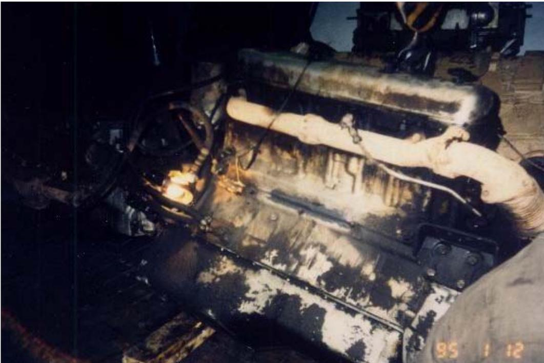
Vier Risse am Zylinderblock eines großen Motors namens „Super MAZ“ wurden mit MM-metall SS-StahlKeramik und Härter gelb repariert. Einer der Risse verlief durch einen Ölkanal und wurde deshalb mit MM-metall oL-StahlKeramik und Härter rot abgedichtet.
