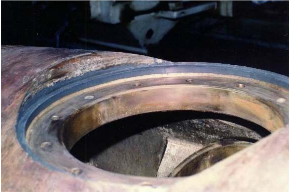
Die Dichtfläche an einem verstellbaren Schiffspropeller wurde mit MM-metall SS-StahlKeramik instand gesetzt.
