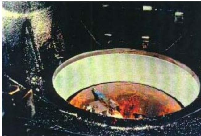
Aus Leckagen an den Dichtflächen der Zylinderlaufbuchse eines Motorblocks lief Kühlwasser in das Nockengehäuse. Der Wiederaufbau wurde mit MM-metall SS-Stahl und Härter gelb an acht Zylinderblockgewinden vorgenommen. Nach der Applikation wurden die Sitze auf Nenndurchmesser 308 mm abgearbeitet. Bei dem Hauptmotor handelte es sich um einen Motor Daihatsu Typ 8 DSM 26, Leistung 1252 kW, 720 U/min.
