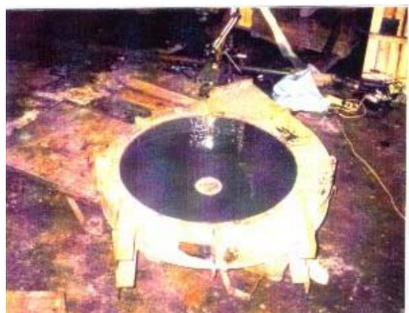
Korrosions- und Abrasionsschäden an Hochdrucklüftergehäusen einer Papierfabrik wurden mit Ceramium, pastös und Härter CE instand gesetzt.
