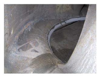
Ein durch Abrasion verschlissener Metallring einer Förderpumpe musste ausgewechselt werden. Mit Hilfe von MM-metall SS-Stahl wurde der neue Metallring befestigt. PolymerMetalle zeichnen sich durch hohe Scherfestigkeitswerte aus; MM-metall SS-Stahl liefert hier einen Wert von 30 MPa.
